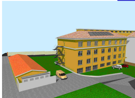
Vista lato sud in cui sono visibili i collettori solari
