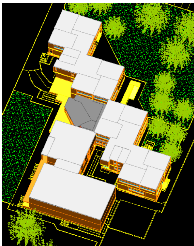
Fig. 26: vista solare 21 Giugno ore 14.00
